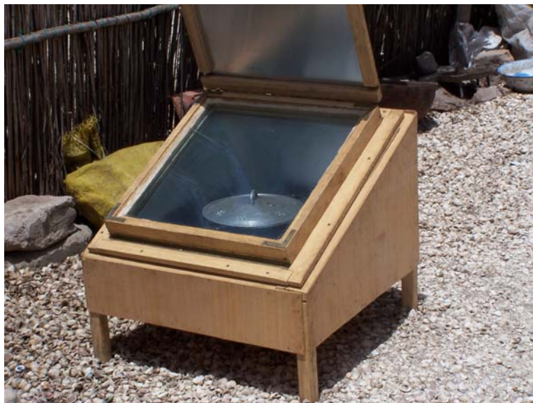
Figure 12 : Four solaire réalisé à Fadiouth
